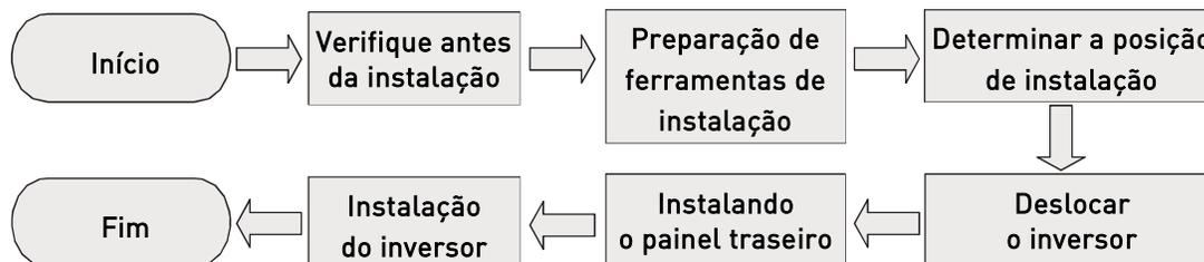
Figura 3-1: Fluxograma de instalação
