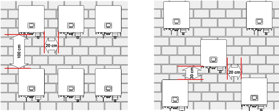
Figura -33: Distância mínima de instalação para vários REFUsol 20K-2T ... 33K-2T
