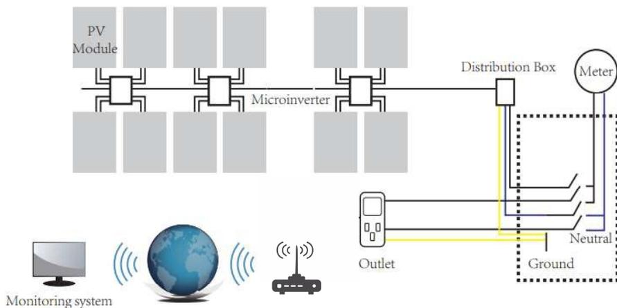
**NOTA:** Se o sinal sem fio na área onde o micro inversor é fraco, é necessário adicionar um amplificador de sinal wi-fi em um local adequado entre o roteador e o micro inversor
