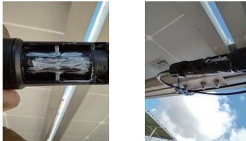
Por favor, preste atenção que o método de desbloqueio dos conectores é diferente de acordo com as leis e regulamentos locais. Durante a construção da usina, o conector não deve ser exposto ao ambiente externo em estado desconectado por muito tempo, de modo a evitar a poeira no ambiente do conector, resultando na perda da confiabilidade da conexão do conector.
