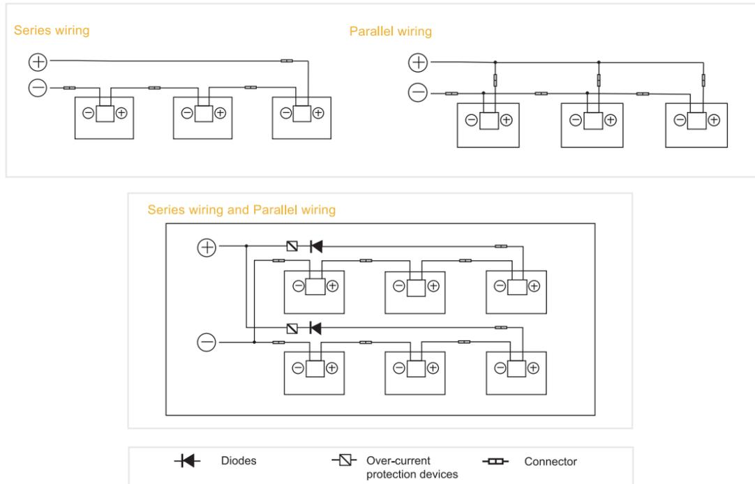
Figure 4 – Diagramas elétricos de conexões séries e paralela
