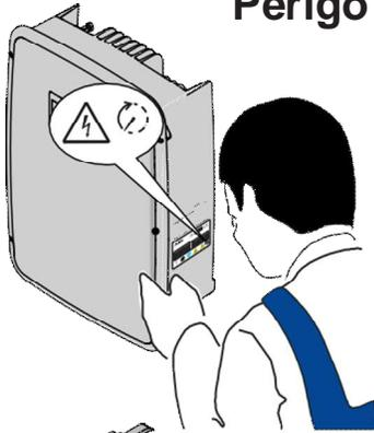
**ADVERTÊNCIA:** a remoção de proteções ou tampas só é permitida depois que a tensão tiver sido removida e o período de tempo indicado na etiqueta tiver passado. Isso é para deixar os componentes esfriarem e permitir que os capacitores internos sejam descarregados.
