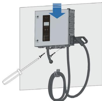
2. Coloque o carregador no suporte. Alinhe o chassi traseiro do carregador com o slot correspondente no suporte. Deslize lentamente o carregador para baixo até que ele se encaixe firmemente no suporte. Aperte dois parafusos na parte inferior.
