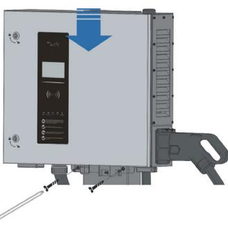
4. Coloque o carregador no suporte. Alinhe o chassis traseiro do carregador com o slot correspondente no suporte. Deslize lentamente o carregador para baixo até que ele se encaixe firmemente no suporte. Aperte dois parafusos na parte inferior.
