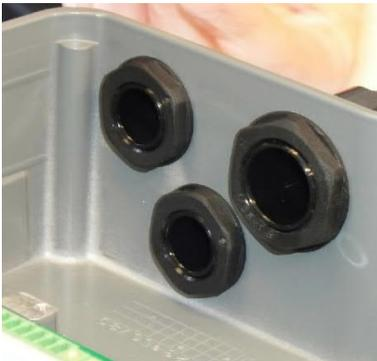
A antena deve ser instalada na parte externa do inversor no lugar de um dos prensa-cabos de serviço (tamanho M20).
