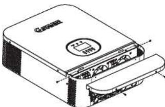
**Passo 2:** Remova a placa de comunicação retirando os dois parafusos, conforme o quadro abaixo.
