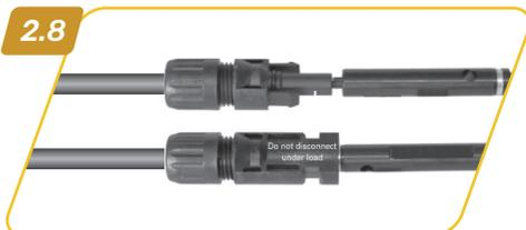
**2.8** Introduzir o pino de inspeção com o lado correspondente no acoplamento macho ou fêmea até chegar ao encosto. Se o contato estiver montado corretamente, a marca branca na ponta do pino de inspeção estará visível.
