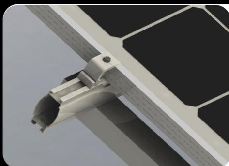
Inserir o grampo terminal no perfil. Certificar-se de que todos os contatos sejam feitos. A chapa de aterramento deve estar alocada entre o módulo e o perfil. Fixar os parafusos dos grampos com torque de 10N.m.
