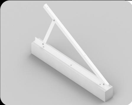
O sistema pode ser ancorado por chumbadores mecânicos (inclusos no kit) ou químicos nos lastros. Os lastros devem ser fixos. Análise as condições locais como velocidade do vento, exposição e altura da edificação para tomada de decisões.
