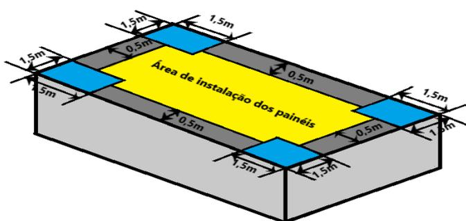
Cada ponto do Brasil existe uma velocidade de vento própria que afeta a distância entre fixadores a ser utilizada na instalação dos painéis. A seguir é apresentado o mapa do Brasil com as diferentes isopletas de velocidade básica dos ventos de acordo com a NBR-6123. Consulte esse mapa para identificar a região da instalação, em seguida a tabela abaixo para saber a distância máxima “d” entre fixadores para módulos de 72 células e posição retrato. Para outras, contatar a Solar Group.
