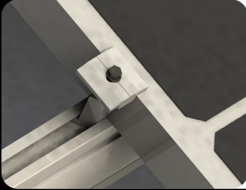
Inserir o grampo intermediário no perfil. Certificar-se de que todos os contatos sejam feitos. A chapa de aterramento deve estar alocada entre o módulo e o perfil. Fixar os parafusos dos grampos com torque de 10N.m.
