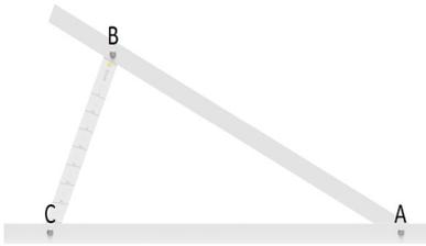
Montar o triângulo fixando os parafusos e porcas nos furos A e B. Por último, realizar o furo C do perfil da base (em formato T) e inserir o parafuso e porca.
